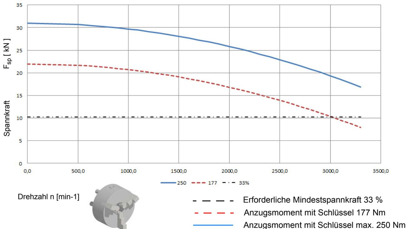
Das Spannkraft-Drehzahl-Diagramm zeigt die rechnerische Fliehkraft mit der zugehörigen Backenausführung in Abhängigkeit der Drehzahl, wenn die Drehfutterbacken nicht über den Drehfutter Außendurchmesser überstehen.
