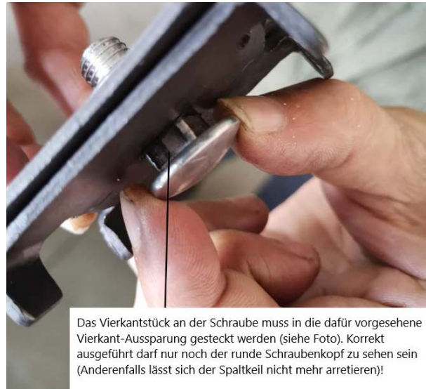
Abb. 19: Spaltkeil montieren Teil 1
