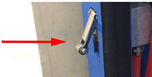
Abb. 5: Mechanischer Tür-Schließmechanismus
