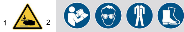
Abb. 1: Sicherheitskennzeichnungen 1 Warnung vor Quetschgefahr für die oberen Gliedmaßen | 2 Sicherheitshinweise: Betriebsanleitung lesen, Augenschutz tragen, Schutzkleidung tragen, Sicherheitsschuhe tragen
