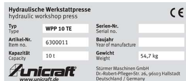
Abb. 3: Typenschild der hydraulischen Werkstattpresse WPP 10 TE
