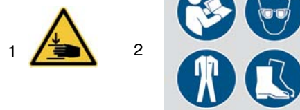
Abb. 1: Sicherheitskennzeichnungen 1 Warnung vor Quetschgefahr für die oberen Gliedmaßen | 2 Sicherheitshinweise: Betriebsanleitung lesen, Augenschutz tragen, Schutzkleidung tragen, Sicherheitsschuhe tragen
