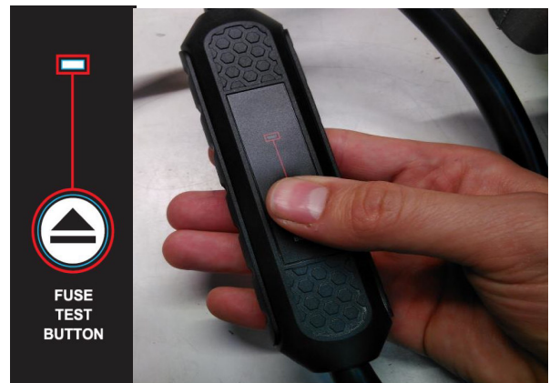
Abb. 9: Sicherung auf Funktion prüfen
