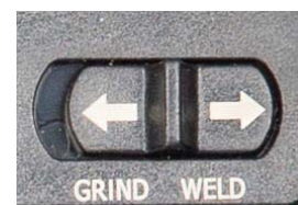
Abb. 6: Wahlschalter für die Betriebsart
