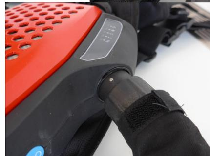
Abb. 12: Schlauchanschluss
