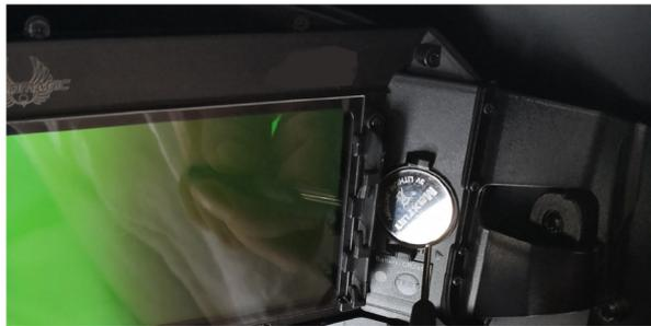
Abb. 21: Batterie einsetzen
