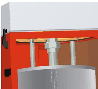
Abb. 6, Lösen der Rotationsdüse
