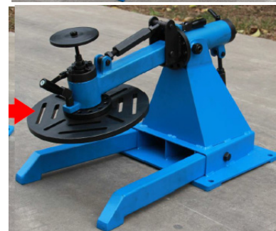
Abb. 8: Winkeleinstellung bei Schweißpositioniervorrichtung SPV 30
