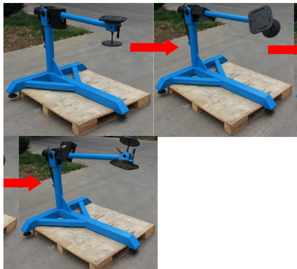
Abb. 7: Winkeleinstellung bei Schweißpositioniervorrichtung SPV 300
