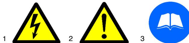
Abb. 1: Sicherheitskennzeichnungen - 1 Warnung vor gefährlicher elektrischer Spannung | 2 Achtung Gefahrenstelle | 3 Betriebsanleitung lesen |
