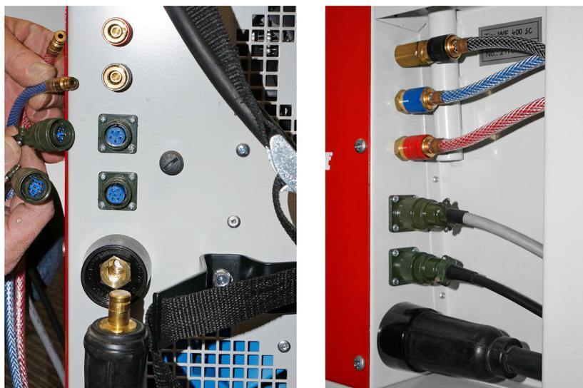
Abb. 5: Anschlüsse für Zwischenschlauchpakete an der Rückseite des Basisgeräts (links) und an der Rückseite des Koffers (rechts)
