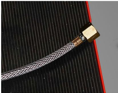
Abb. 6: Anschluss der Gasleitung am Druckminderer
