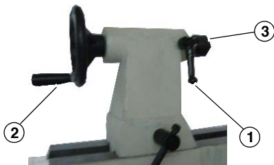
Abb. 13: Auswechseln der mitlaufenden Reitstockspitze
