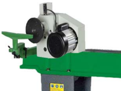
Abb. 18: Werkzeugauflage links montiert
