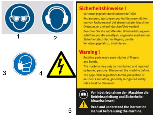
Abb. 1: Gebotszeichen: 1 Augenschutz benutzen | 2 Gehörschutz benutzen | 3 Staubmaske tragen Sicherheitskennzeichnungen: 4 Warnung vor gefährlicher, elektrischer Spannung | 5 Sicherheitshinweise
