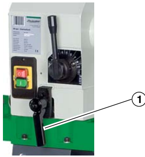
Abb. 10: Montage der Spindelstockklemmung
