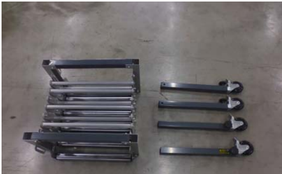
Abb. 1: Montageteile der Scherenrollenbahn
