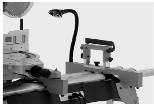
Abb. 13: Montage Rollenauflage auf der Maschinenaufgabe
