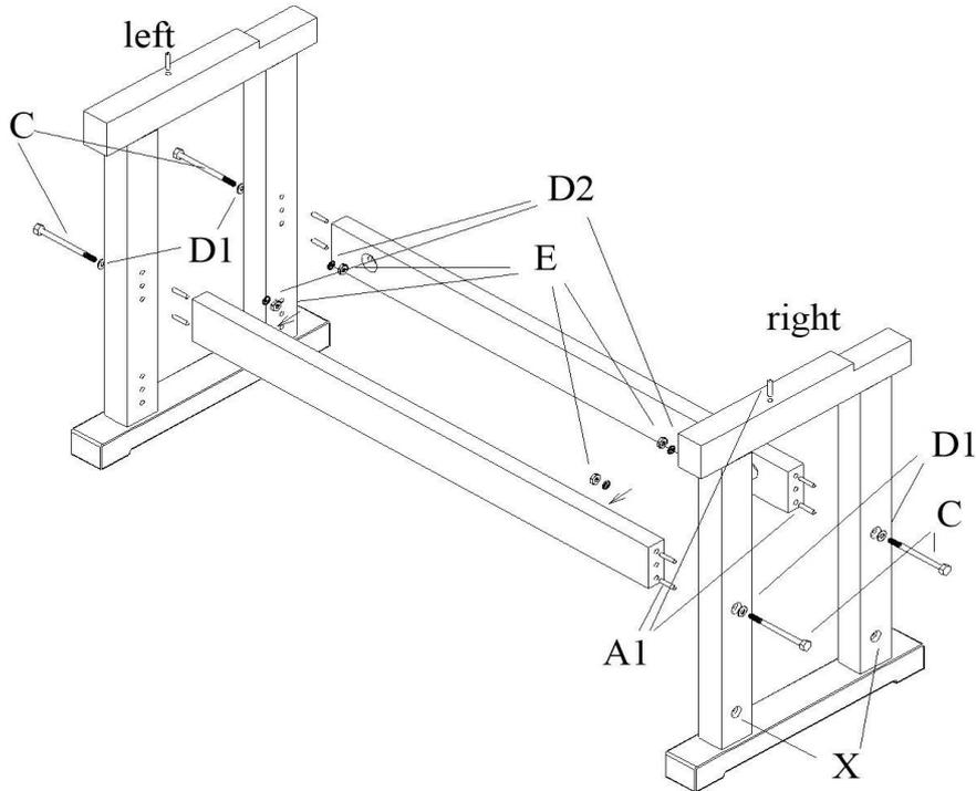
X = Bohrungen für die Querbalken, wenn ein Untergestell verwendet wird!
