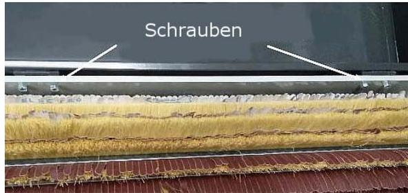
Abb. 33: Schleifwalze einsetzen
