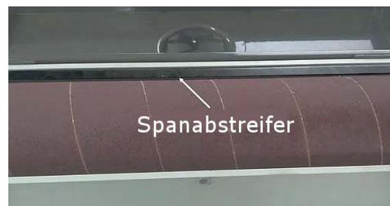
Abb. 32: Späneabstreifer entfernen
