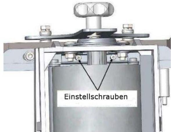
Abb. 20: Einstellschrauben Druckwalzen
