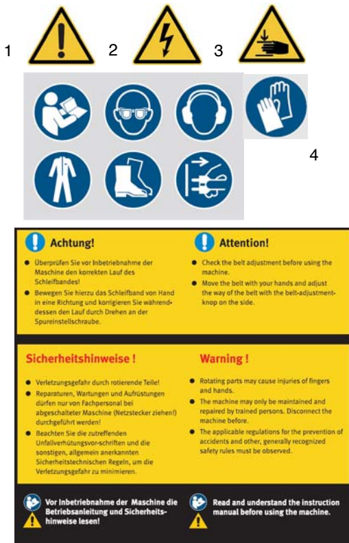
Abb. 1: Sicherheitskennzeichnungen 1 Warnung vor Gefahren | 2 Warnung vor gefährlicher elektrischer Spannung | 3 Warnung vor Quetschgefahr für die oberen Gliedmaßen | 4 Gebotszeichen / Sicherheitshinweise
