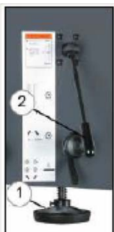
Abb. 11: Einstellen der Bandspannung
