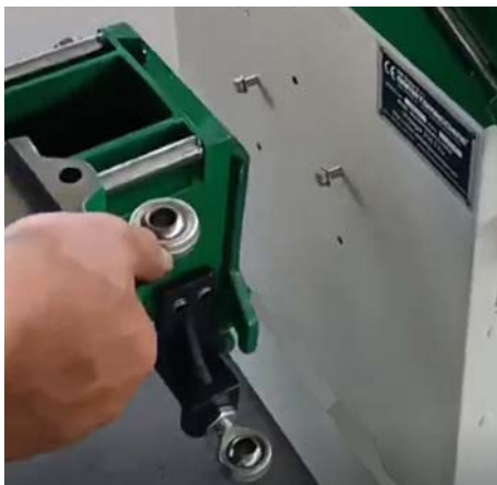
Abb. 9: Montieren der Langlochbohrereinrichtung
