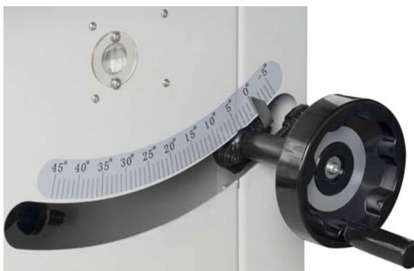
Abb. 31: Skala zur Einstellung des Neigungswinkels
