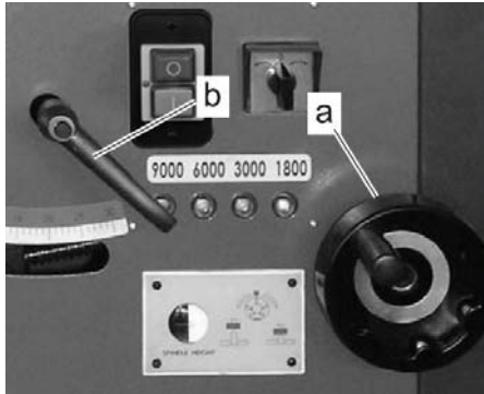
Abb. 30: Neigungswinkels der Spindel einstellen
