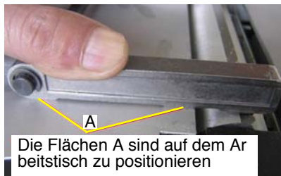
Abb. 32: Einstellen der Hobelmesser auf Fläche B
