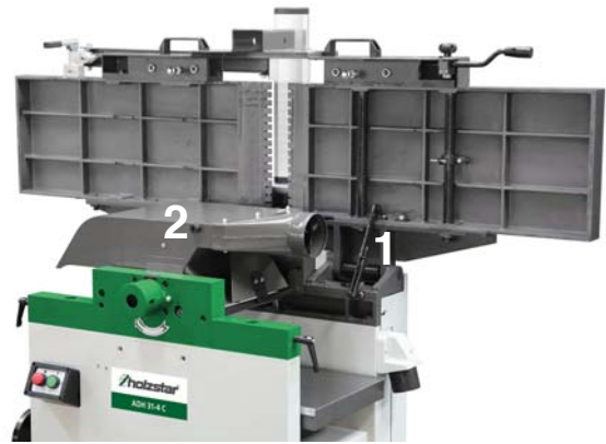
Abb. 9: Umbau zur Dickenhobelfunktion
