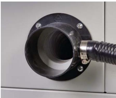
Abb. 15: Absauganschluss montieren
