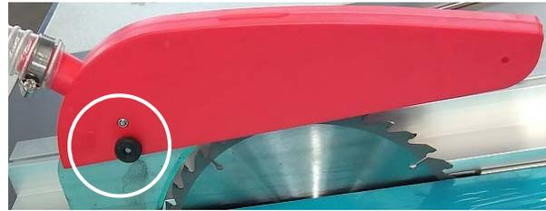
Abb. 16: Sägeblattschutz montieren
