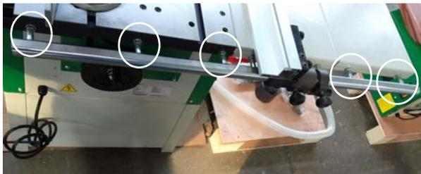
Abb. 8: Anschlag-Führungsschiene montieren
