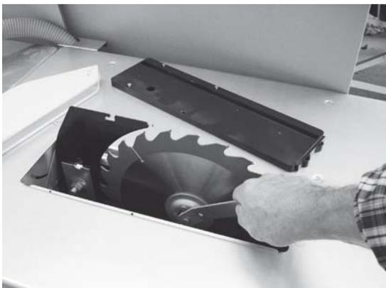
Abb. 39: Sägeblatt lösen mit dem Sägeblattschlüssel
