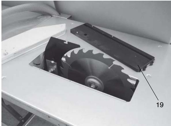
Abb. 38: Tischeinlage entfernen
