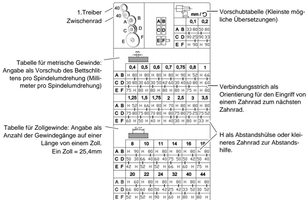
Abb.4-5: Beispiel Wechselradtable
