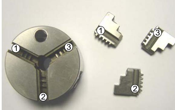
Abb. 4-3: Dreibackenfutter / Spannbacken
