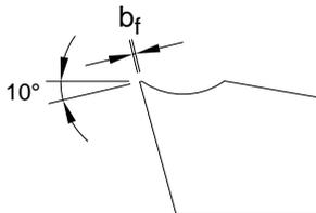
Abb.4-21: Stabilisierte Schneidkante
