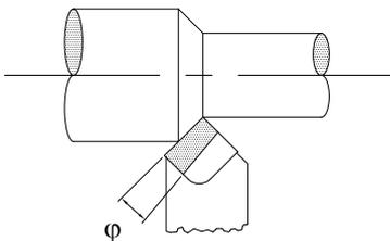
Abb.4-18: Positiver Öffnungswinkel zum Schlichten
