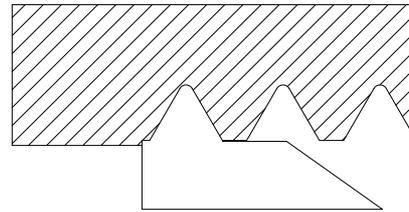
Abb. 4-29: Vollprofilschneidplatte
