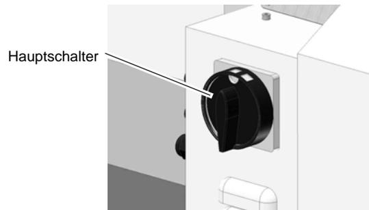
Abb. 1-3: Hauptschalter abschließbar
