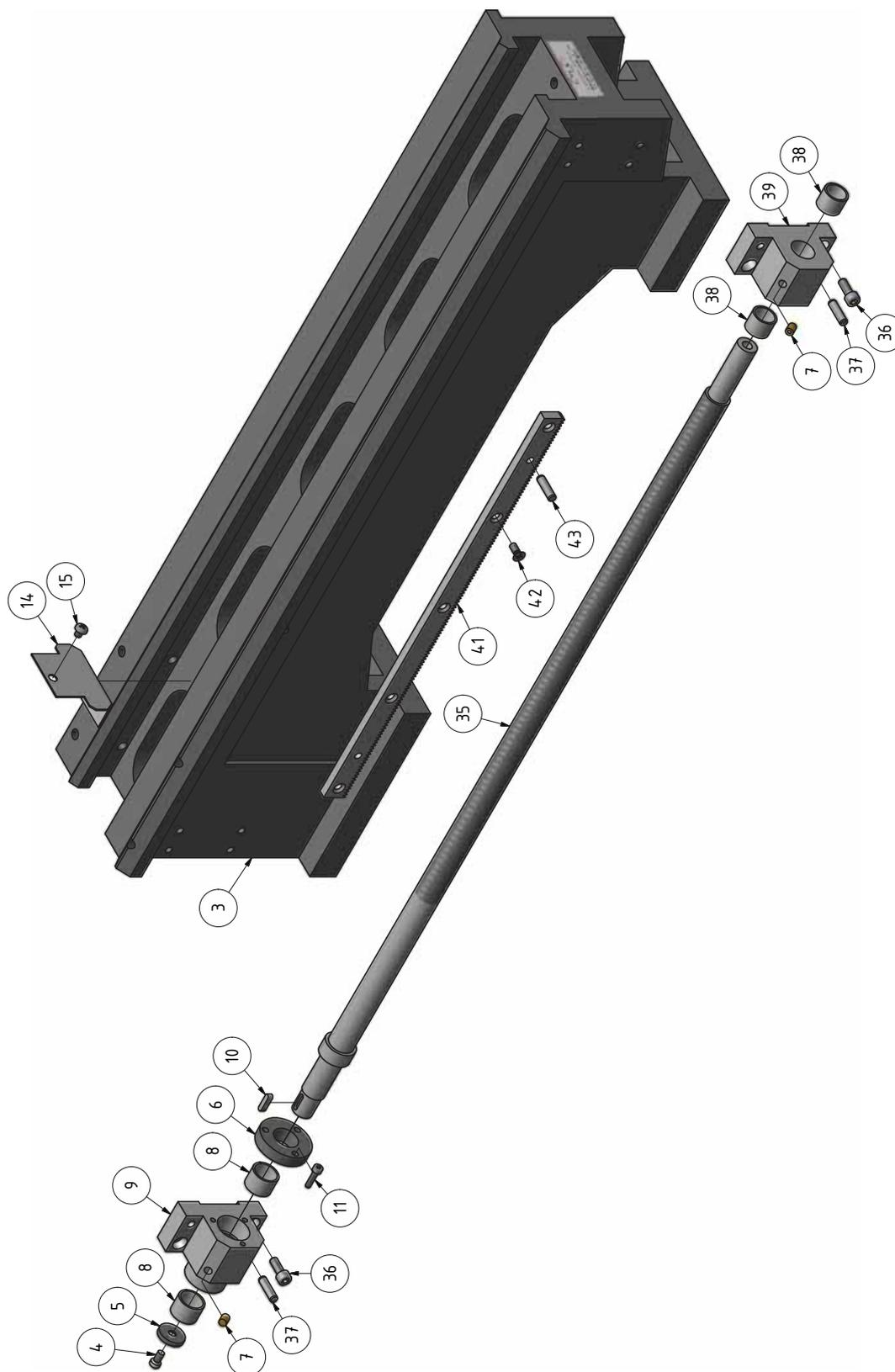
Abb.6-8: Maschinenbett - Lathe bed
