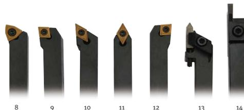
➔ Der komplette Klemmhalter oder Drehmeißel muss mit Blechen unterlegt werden, um genau auf Drehmitte zu kommen.
