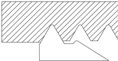
Abb. 4-28: Teilprofilschneidplatte
