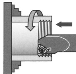
Abb.4-27: Innengewinde drehen
