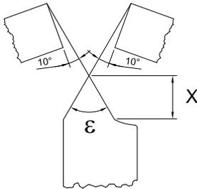
Abb.4-23: Anschlag zum Gewindedrehen
