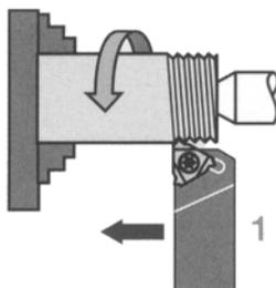
Abb.4-26: Aussengewinde drehen
