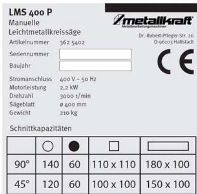
Abb. 2: Typenschild und CE-Kennzeichnung der Metallkreissäge LMS 400 P
