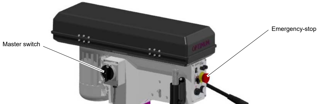
Img. 1-1: Master switch
