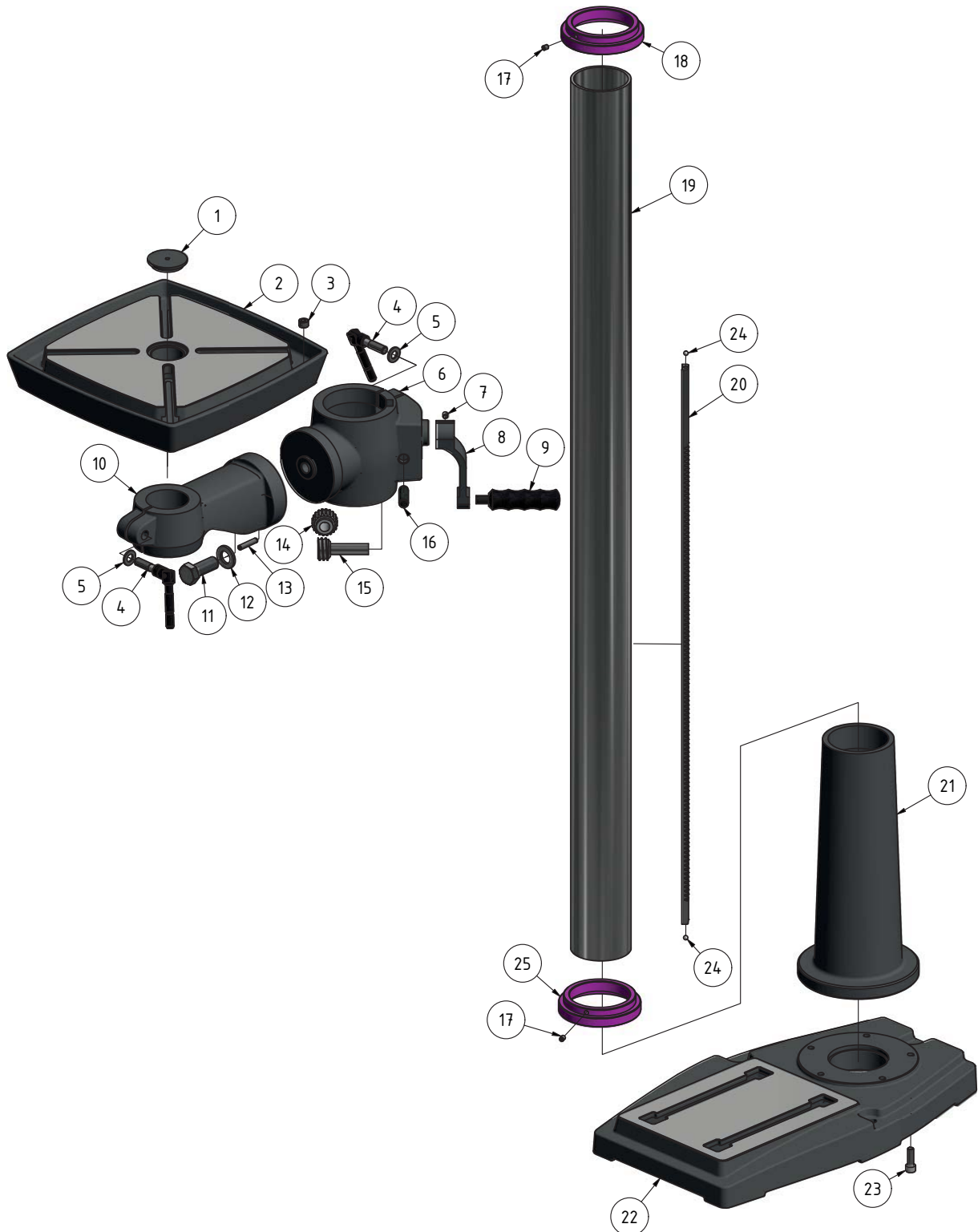
8-4: Säule, Bohrtisch - Column, drilling table
