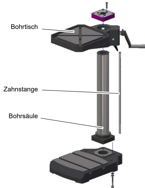
Abb. 3-2: Montage Bohrtisch B24H
