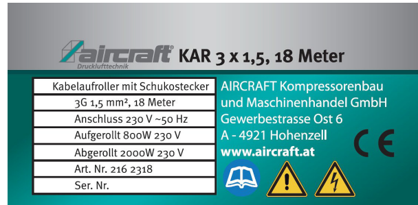
Abb. 1: Typenschild Kabelaufroller KAR 3x1,5 18 Meter
