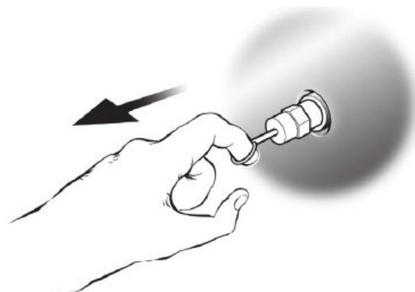
Abb. 21: Sicherheitsventil Version A
