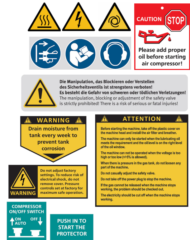
Abb. 1: Sicherheitssymbole am Kompressor
