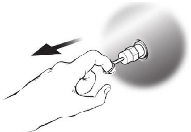
Abb. 12: Sicherheitsventil Version A
