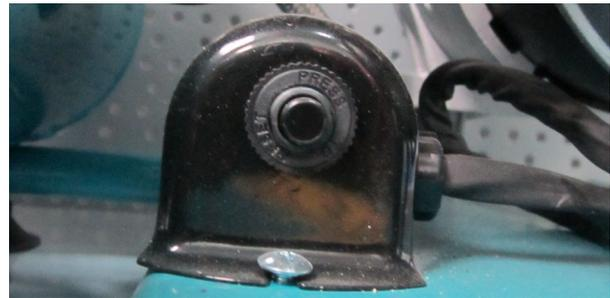
Abb. 7: Motorschutzschalter
